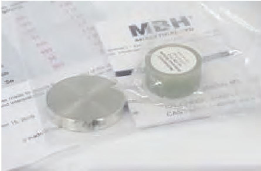
ภาพที่ 4-10 อุปกรณ์ใช้ในการตรวจสอบค่าความเที่ยง
