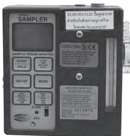
ภาพที่ 4-4 ตัวอย่างปั๊มเก็บตัวอย่างอากาศชนิดติดตัวบุคคล
